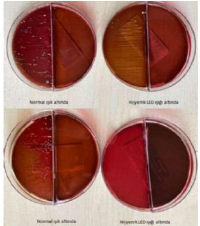
Şekil 1. Normal ışık ve HLL ışığının havadaki mikrobiyal yüke etkisi belirlemek için petri açma yöntemi ile yapılan testler
